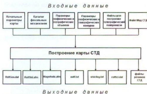
Рис. 6. Структура входных данных, используемых при построении карты сейсмических событий и возможные выходные данные, которые могут быть сформированы после выполнения режима построения
