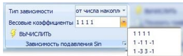
Рис. 3.45 Выбор весовых коэффициентов для алгоритма синхронного весового накопления
