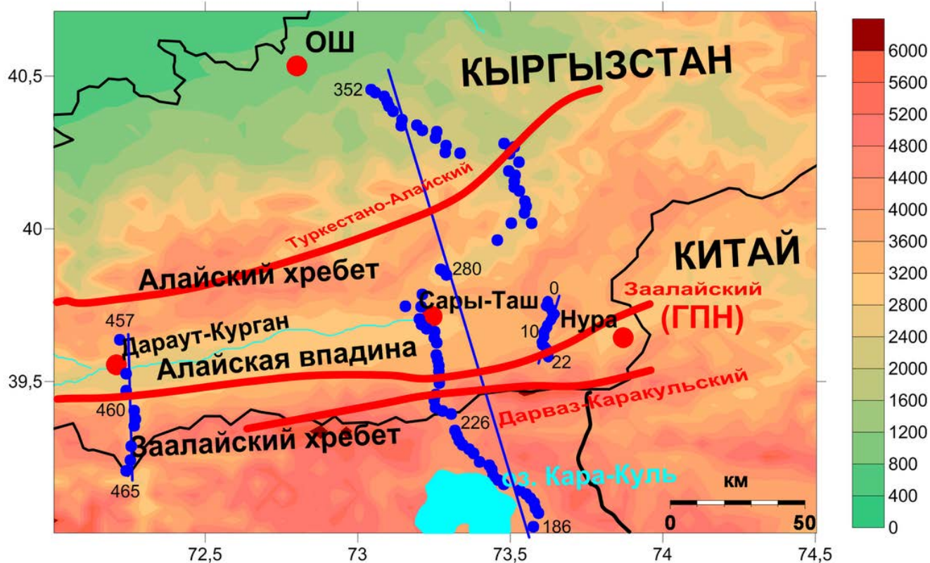
Рисунок 3.1 – Карта-схема расположения магнитотеллурических профилей «Дараут-Курган», «TIPAGE-ALAI» и «Нура», пересекающих Алайскую впадину. Синие кружки - пункты МТЗ-МВЗ; синие линии – профили МТЗ-МВЗ (с запада на восток: «Дараут-Курган», «TIPAGE», «Нура»); красные кружки – ближайшие населенные пункты; красные линии – основные разломы: ГПН – Главный Памирский надвиг (Заалайский разлом).
