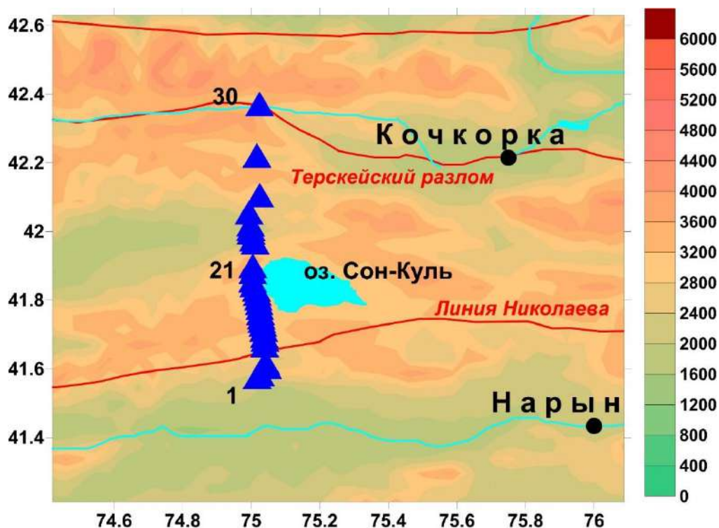
Рис. 1.3.1-1. Карта-схема расположения МТ профиля «Сон-Куль», выполненного в 2019 году, секущего в меридиональном направлении поднятие Молдо-Тоо, Линию Николаева и Центрально-Терсейский разлом. Синими треугольниками показаны пункты магнитотеллурических зондирований.
